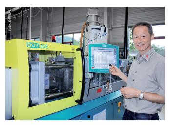
Das über die neue Universal-Spritzeinheit der Boy 35E mögliche Differential-Einspritzen sorgt für die richtige Kombination aus Einspritzdruck und Geschwindigkeit in der Dünnwandtechnik.
