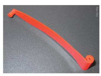
Der Fließweg dieser nur 0,4 mm dicken Bandspule beträgt rund 100 mm; die Spule wird am dickwandigeren Ende (li. u.) rund um die Bohrung angusslos angespritzt. Das Wanddicken-Fließweg-Verhältnis liegt hier bei 1:250.
