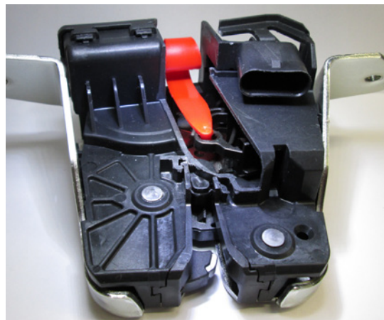
Heckklappensystem „soft open-soft close“
