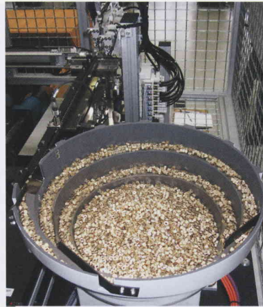
Über einen Bunker erfolgt die Vereinzelung und lageorientierte Zuführung der Metallbuchsen Foto: Fleig
